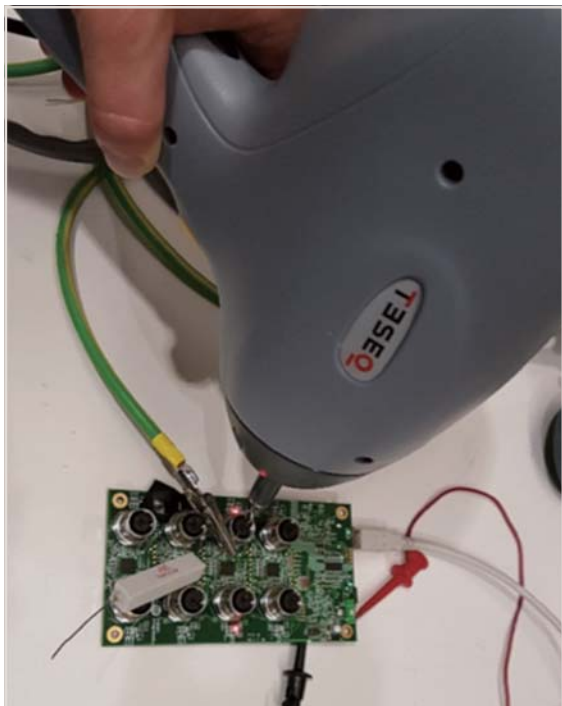
그림 29. MAX14819의 ESD 테스트
